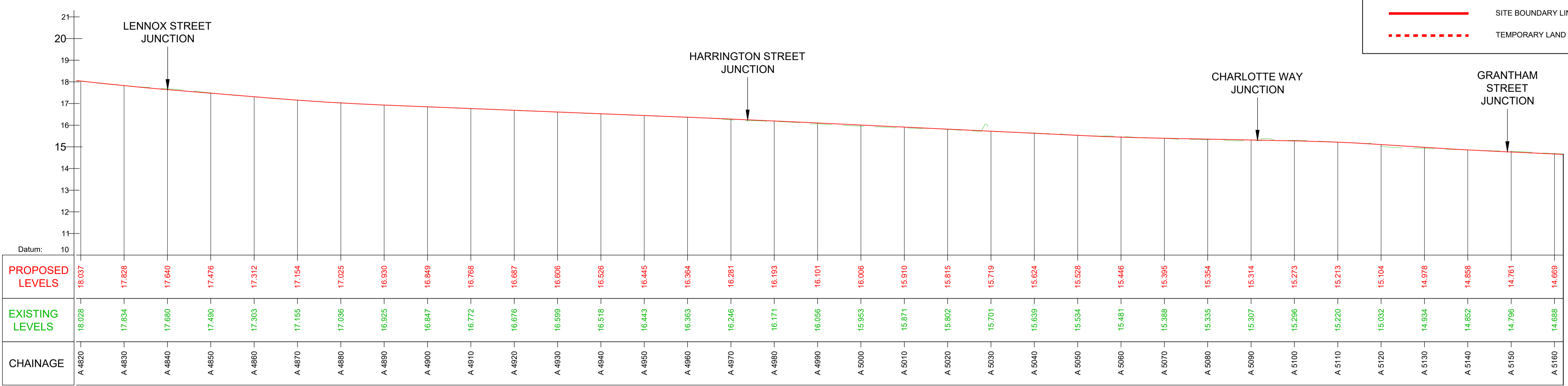
GEO_HV-0012_ML_01-M3-CR-0001-A02 LONGITUDINAL SECTION SCALE: H 1:500, V 1:100
